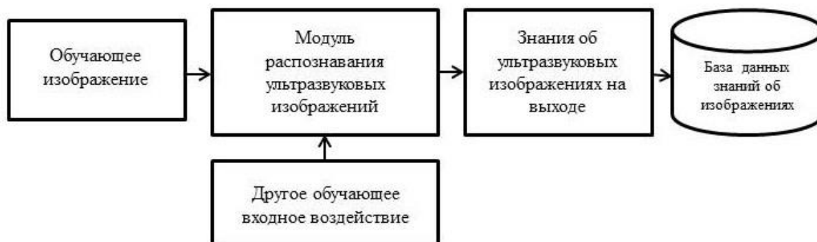
Рис. 2. Блок-схема, объясняющая модель обучения модуля распознавания ультразвуковых изображений
